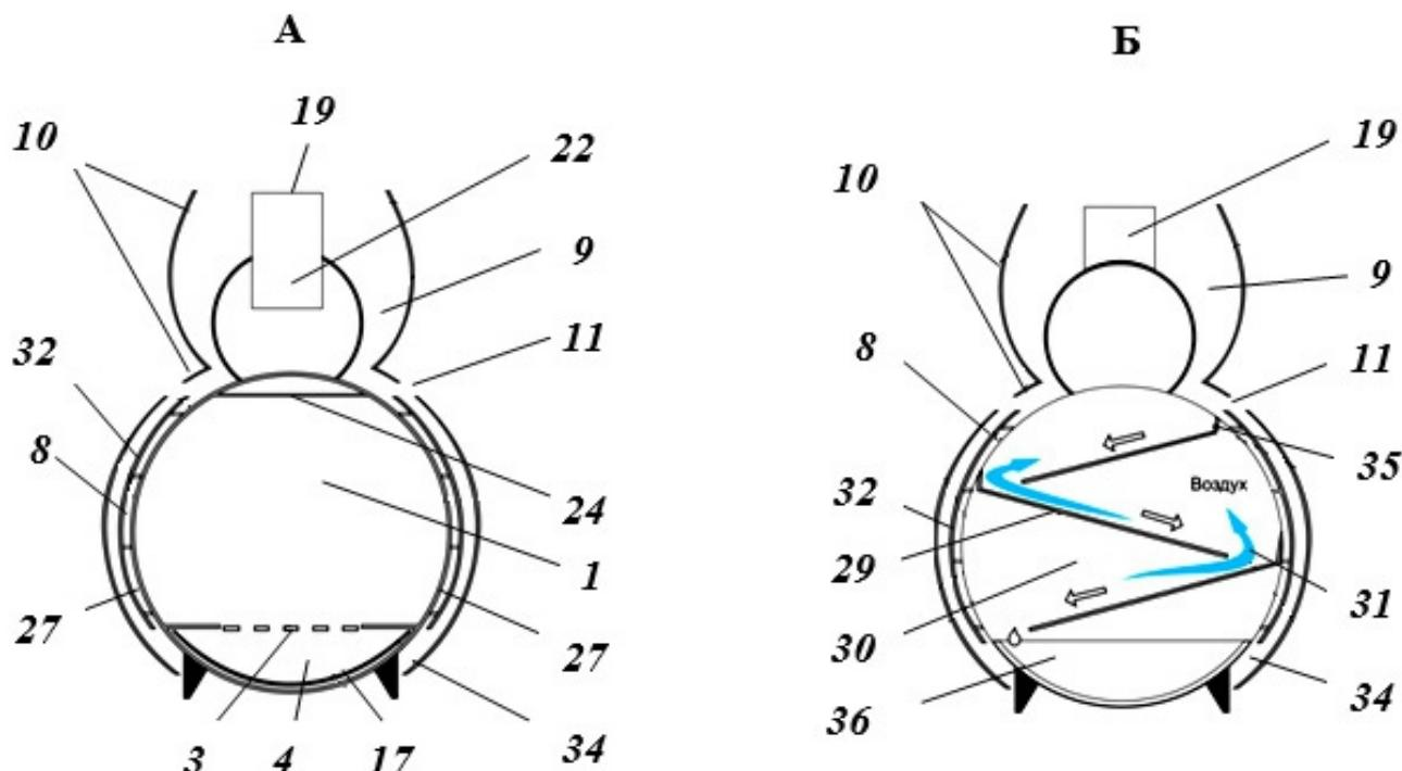
Корпус 1 предпочтительно выполнен из жаростойкой стали. На передней стенке 14 топочной камеры 1 расположена дверка 2, которая плотно прилегает к передней стенке 14, исключая подсос воздуха с помощью затворного устройства 15. При этом дверка 2 имеет круглую форму, для наблюдения за огнем и регулировки его горения 16 из термостойкого светопрозрачного материала из термостойкого стекла. Колосниковая
